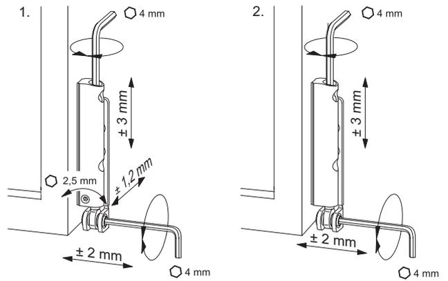
1. mit Anpressdruckverstellung
